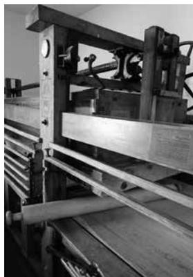
Jetzt drückt der mit Steinen gefüllte und ca. 1.500 kg schwere Holzkasten auf die Dogge. Durch eine Zahnstange wird er horizontal bewegt, wobei an den Endstellungen die Zahnstange so umgelegt wird, dass er nun in die andere Richtung läuft. Das geschieht drei-mal und ein mechanisches Zählwerk veranlasst auf der Gegenseite das Öffnen des Scherengitters. Der Motor läuft zwar weiter, ist aber mittels einer Kupplung von dem Antrieb getrennt. Die fertige Dogge kann entnommen und in die
